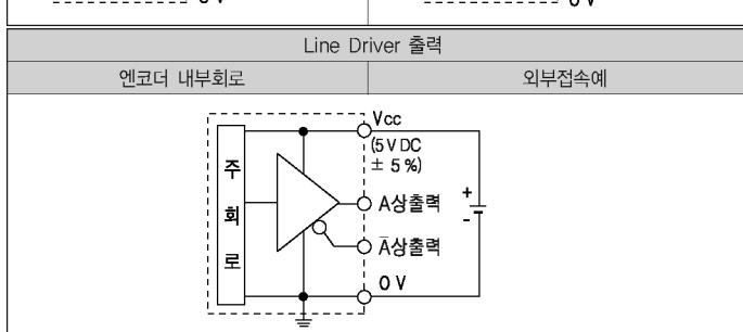
\* 출력회로는 A, B, Z상 (Line Driver 출력은 A, A-bar, B, B-bar, Z, Z-bar상) 모두 동일합니다.
